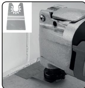
2. ábra. Ragasztó- és tömítőanyag maradványok eltávolítása kaparóval.
