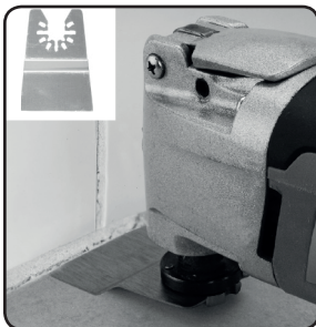
Obr.2, odstraňování zbytků lepidla či tmelů škrabkou
