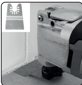
Abb.2, Entfernung von Leim- oder Fugenmassenresten mit einem Schaber
